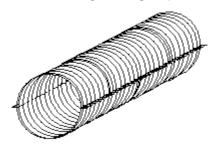
SON CONFORMADAS CON DOS SECCIONES DE LAMINA CORRUGADA Y ROLADA (MEDIA CAÑA). LA UNIÓN SE LLEVA A CABO MEDIANTE TORNILLOS DE ALTA RESISTENCIA.
